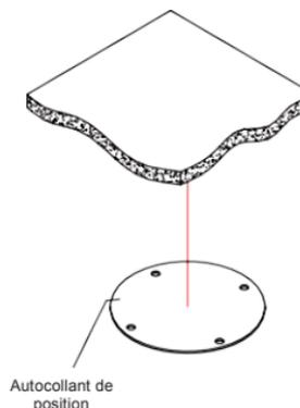
Appliquez l'autocollant de position sur la position de montage de la caméra souhaitée
