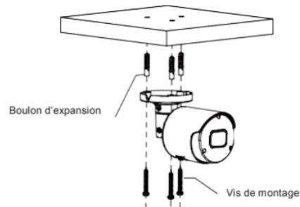
Insérez trois boulons d'expansion en place dans le plafond et fixez l'équipement avec trois vis de montage.
