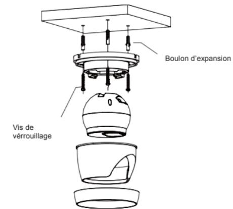
Fixez le piédestal en perçant des trous de verrouillage autour de l'autocollant et en insérant trois boulons d'expansion dans les trous et en le fixant avec trois vis de verrouillage.
