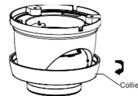
Retirez le collier de l'appareil photo en le faisant tourner vers le bas.
