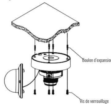
Utilisez la position indiquée sur l'autocollant de position pour percer les trous nécessaires au montage de la base de la caméra. Insérez le boulon d'expansion dans les trous. Faites correspondre les ouvertures de montage de la base à la position des boulons d'expansion, puis placez les vis de montage à travers l'ouverture de montage de la base dans le boulon d'expansion. Serrez les vis de montage pour vous assurer que la base de la caméra est bien montée
