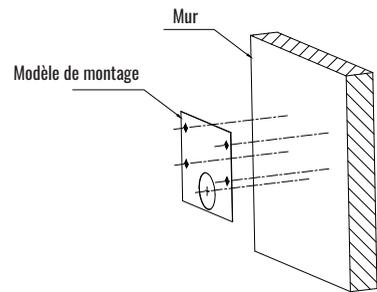
Étape 1 : Coller le modèle de montage sur le mur, percer 4 trous de vis et 1 trou pour le câble d'alimentation.
