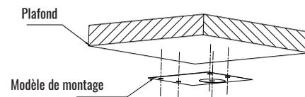
Étape 1 : Coller le gabarit de montage sur le mur, percer 4 trous de vis et 1 trou pour le câble d'alimentation.
