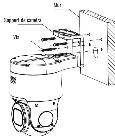
Étape 3 : Aligner le support de la caméra sur les 4 trous de vis des particules colloïdales gonflantes et verrouiller les vis pour les fixer.
