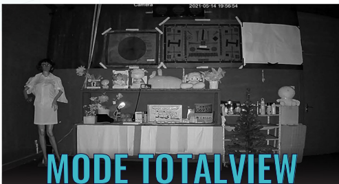
CAMÉRA NORMALE MODE COULEUR / LEDS IR ON / 0 LUX
